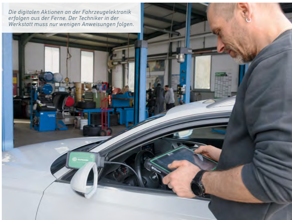
An die OBD-Dose anschließen und Zündung anschalten: Drei LEDs am macsRemote signalisieren, dass sich das Device automatisch mit dem Remote Center verbindet – gutes WLAN vorausgesetzt.
