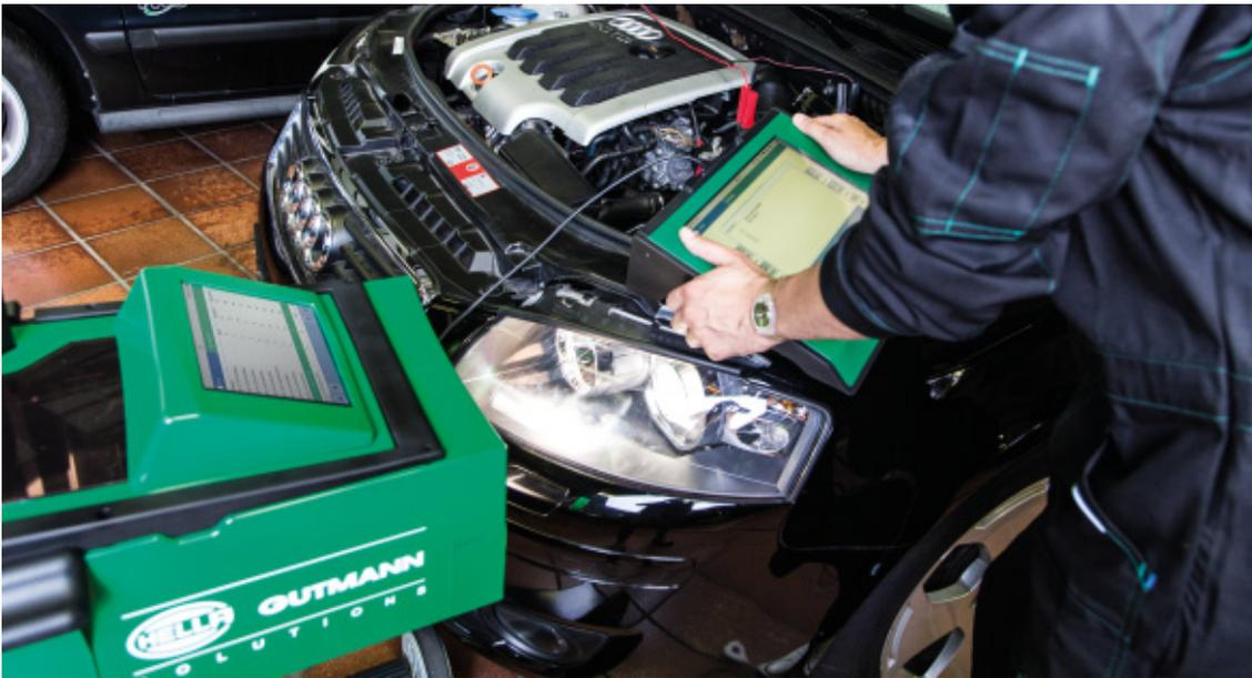
Anhand hinterlegter Algorithmen für unterschiedliche Scheinwerfer und deren Lichtverteilungen liefert SEG V eindeutige Abbildungen. Fehlinterpretationen lassen sich somit sicher ausschliessen.
