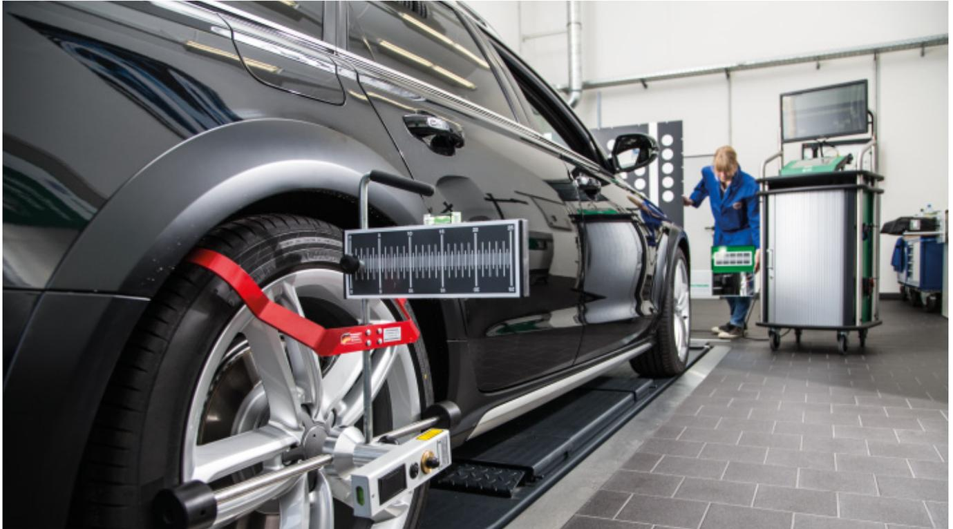
**In Verbindung mit jedem aktuellen mega macs ermöglicht der CSC-Tool-Baukasten jetzt die fachgerechte Kalibrierung von Kameras in Audi, BMW\*, Ford\*, Seat, Skoda, Volvo\*, VW, Mitsubishi\*, Mercedes und in Kürze sechs weiteren Marken. Ausserdem stehen ab sofort Erweiterungen für die Justierung der derzeit gängigen Radarsysteme zur Verfügung.**
