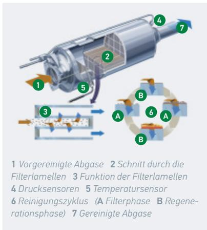
1 Vorgereinigte Abgase 2 Schnitt durch die Filterlamellen 3 Funktion der Filterlamellen 4 Drucksensoren 5 Temperatursensor 6 Reinigungszyklus (A Filterphase B Regenerationsphase) 7 Gereinigte Abgase
