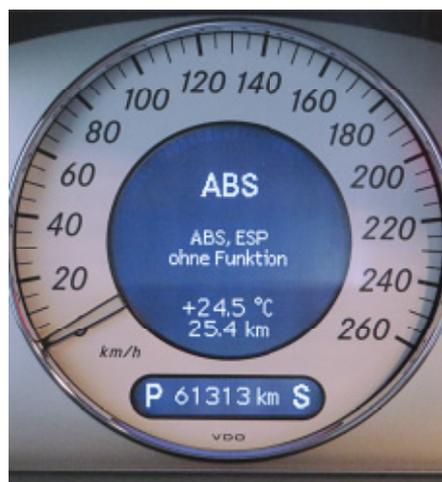
*Die Krux der vernetzten Systeme: Bei Unterspannung der Batterie funktioniert die SBC (Sensotronic Brake Control) von Mercedes nicht mehr und es lässt sich keine Fahrstufe mehr einlegen.*
