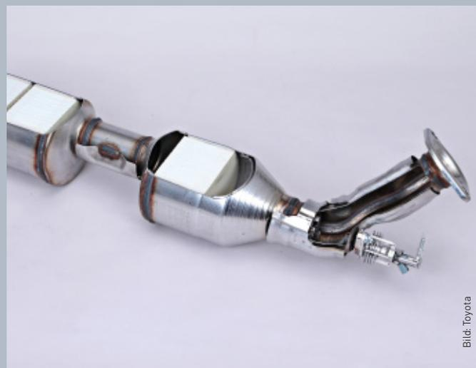
Toyota erreicht bei den neuen Euro-6-Selbstzündern via Doppel-SCR mit AdBlue-Einspritzung 99 Prozent Stickoxid-Reduktion.
