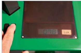
Über das **digitale Luxmeter** können der Blendwert des Abblendlichts sowie die Beleuchtungsstärke des Fernlichts schnell und präzise ermittelt werden.
