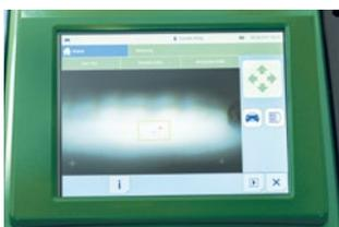
Ein zum Anwender gerichtetes **8,4"-Touch-Display\*** zur einfachen und intuitiven Bedienung zeigt ein detailliertes Bild, bei dem Charakter und Eigenschaften der Lichtverteilung erhalten bleiben.
