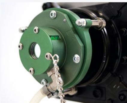
Teil des CSC Kit Radar II: Spiegeljustiervorrichtung für Sensoren ohne Spiegelsystem.
