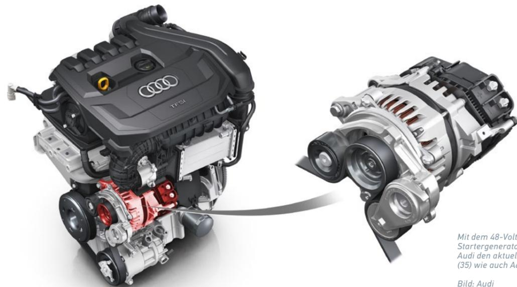
Mit dem 48-Volt-Riemen-Startergenerator hybridisiert Audi den aktuellen A3 1.5 TFSI (35) wie auch A6, A7 und A8.
