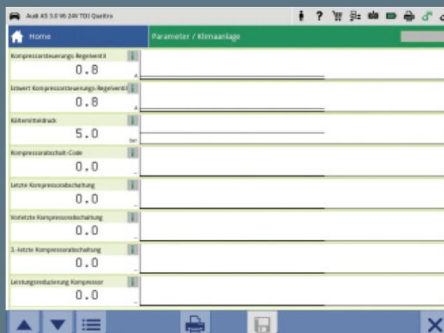
Der Parameter „Ansteuerung Regelventil“ zeigt, dass der Kompressor angesteuert wird. Die Fehlersuche grenzt sich somit auf die Mechanik ein.
