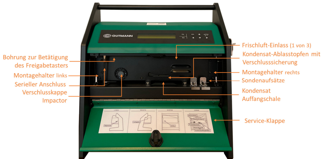
Bild 6: HG4-PCK – Service-Klappe (offen)
