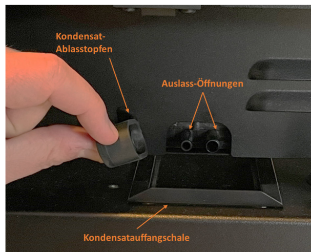
Bild 25: Kondensatauslass und Auslassstopfen
