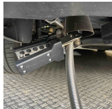
Bild 11: Messsonde in Abgasrohr einführen
