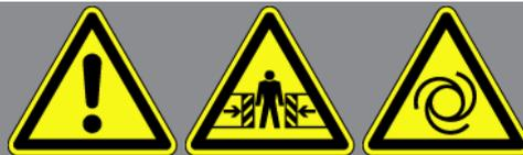
Bei Arbeiten am Fahrzeug besteht Verletzungsgefahr durch sich drehende Teile oder Wegrollen des Fahrzeugs. Deshalb Folgendes beachten:
