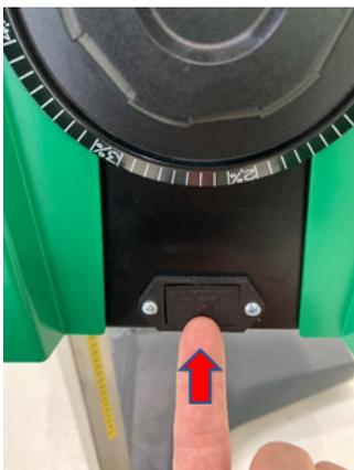
2. Den Batterieträger nach hinten aus dem Batteriefach ziehen.
